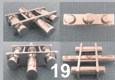
FABRICADAS EN ACERO INOXIDABLE T-316 O T-304, CON MAGNETOS DE ALTA POTENCIA DE NEODIMIO GRADO N42 DE 13,700 a 14,300 GAUSS O IMÁN CERÁMICO Y34 DE 4,200 a 4,400 GAUSS, CON O SIN DESVIADOR DE MATERIAL, CON O SIN MARCO COMPLETO. CUALQUIER MEDIDA Y DISEÑO.
